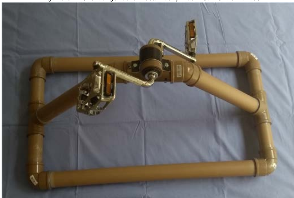
Figura 5 - Cicloergômetro mecânico produzido manualmente.
