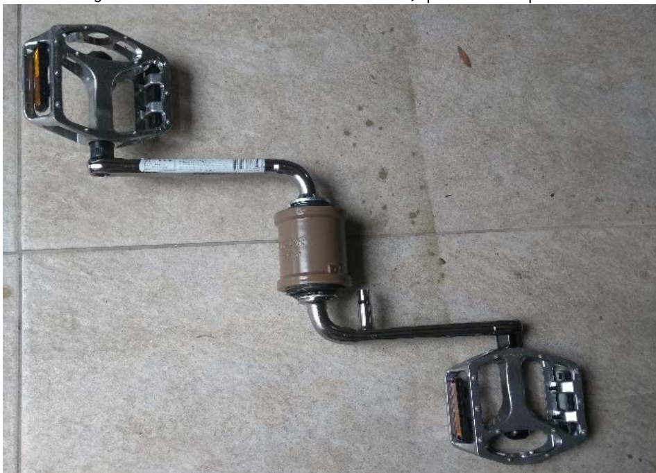
Figura 3 - Luva de PVC com rolamento, pedivela e pedais.
