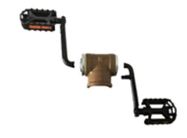
Passo 4: A base vertical será encaixada na região superior, devido ao 'joelho' que fará a ligação dessas duas partes, onde estão localizados os pedais.
