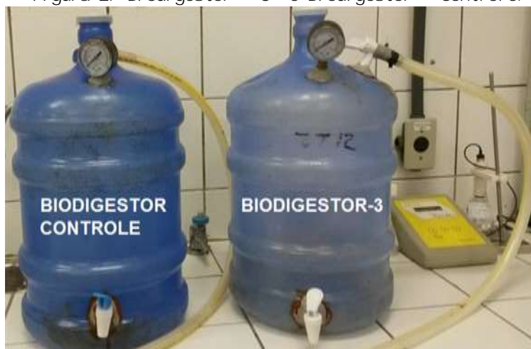
Figura 2: Biodigestor - 3º e Biodigestor - controle.
