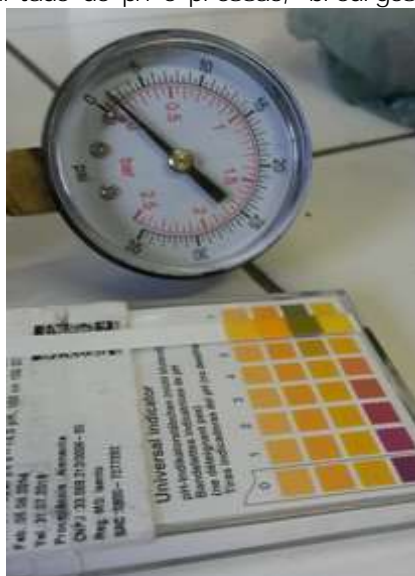
Figura 6: Resultado de pH e pressão, biodigestor secundário.
